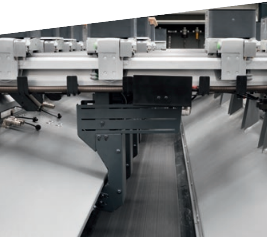
Tapis motorisé pour l'évacuation des copeaux et déchets.
