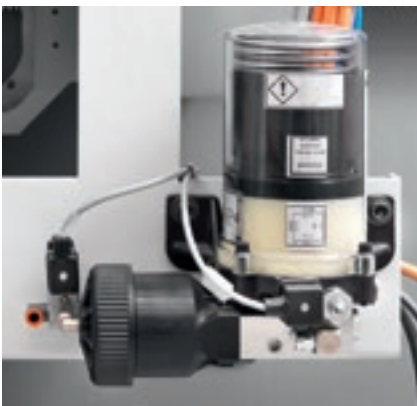
Lubrification automatique tête de perçage BHZ 29 2L.
