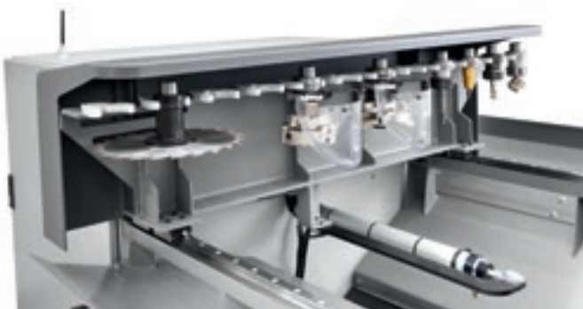
Magasin outils à râtelier 12 positions avec pick-up intégré.
