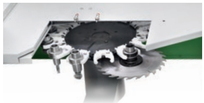
Magasin outils à revolver 13/16 positions.
